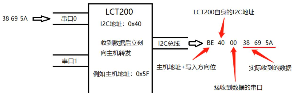
**通讯模式为读写模式：** 读写模式下，无需配置主控 MCU 的 I2C 地址，LCT200 收到串口数据后，会把数据缓存在内部的内存中，等待主控 MCU 以 I2C 读取的方式取出数据。每一路串口最多可以保存 192 字节数据，并采用先进先出的逻辑进行传递，如果没有及时取出保存在内部的数据，当 LCT200 收到的数据达到保存的最大值后，新的数据会把最先保存的数据替换掉，所以，如果串口数据量较大，用户需要及时通过 I2C 将数据读取出来，避免丢包、残包的情况。具体操作如下：当串口 0 接收完一组数据后，SIGNAL0(5 脚)会主动下拉 100ms，当主控 MCU 接收到引脚下拉后，用 I2C 接口写入一个字节 0x00，代表接下来读取串口 0 的缓存数据，然后按照用户预计的数据长度读取数据，**读取到的第一个字节代表此时该串口 0 内部已经保存的数据长度**，用户读取的长度如果小于内部保存的长度，那么没有读取的数据依然保存在 LCT200 内部，等待下一次读取。如果读取长度超过实际接收到的部分，读取到的数据为 0x00。
